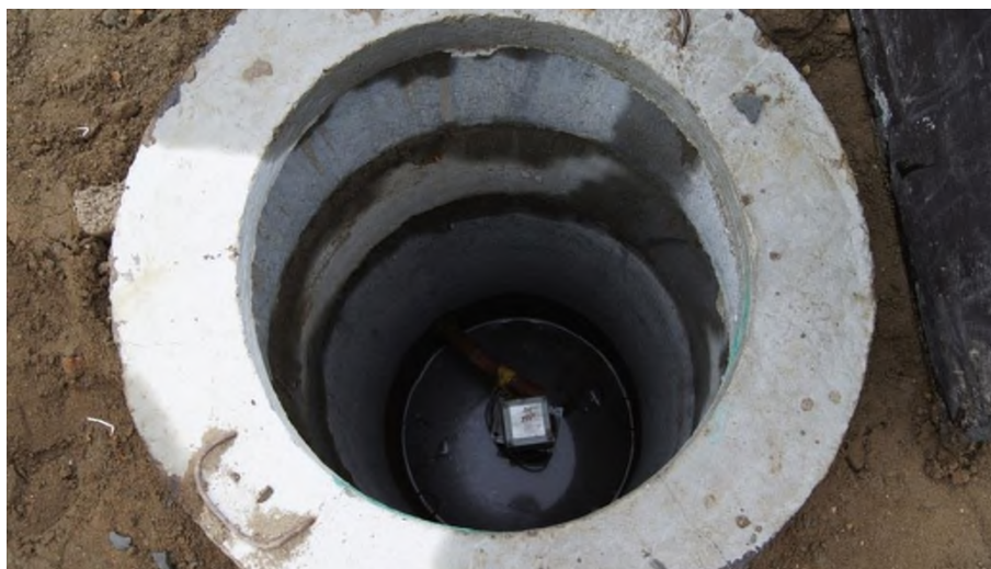
Рисунок 4 – Общий вид колодца для грунтового датчика ускорений
