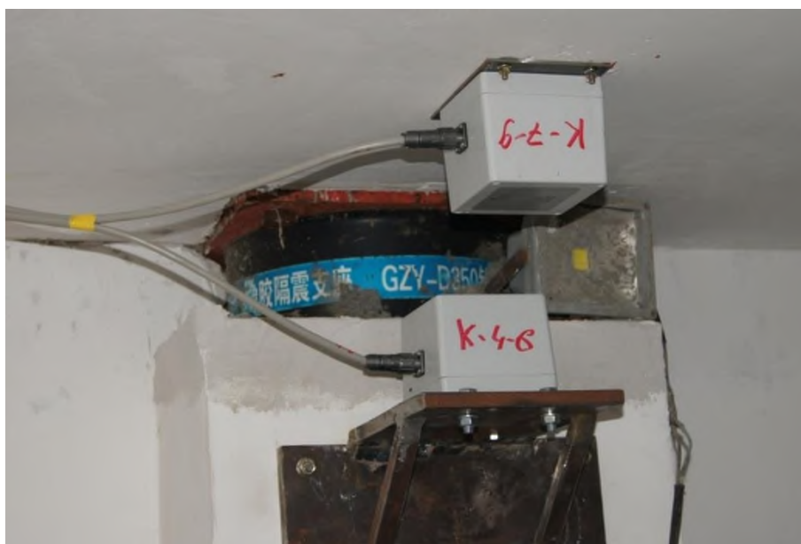
Рисунок 5 – Общий вид датчиков ускорений в уровне «0», «+1»
